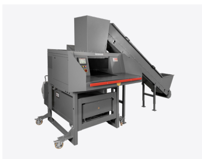
Variante 2 : intimus 16.99 SmartShred avec presse à balles pour compacter les particules au fur et à mesure de la destruction
