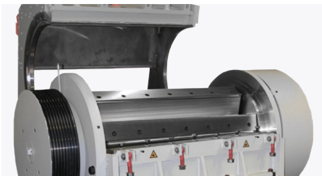
Messer aus hochwertigem, gehärtetem Werkzeugstahl (Abbildung ähnlich)
