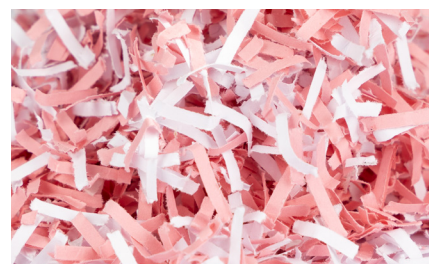
2 x 15 mm Partikel der Sicherheitsstufe P-5 nach DIN 66399 (ISO/IEC 21964)
