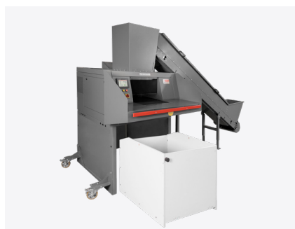
Variante 1: intimus 16.99 SmartShred mit Auffangbehälter zur Sammlung des losen Schnittguts
