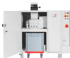
88-Liter-Sammelbehälter mit Füllstandüberwachung
